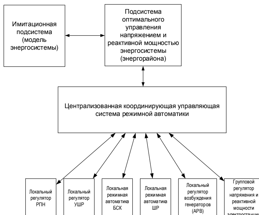
Рис. 4.4 – Обобщенная структура комплекса управления напряжением.
