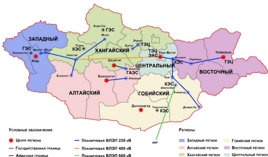
Рисунок 1.27 – Новая схема экономического зонирования Монголии с указанием географического размещения намечаемых новых энергетических источников и воздушных линий электропередачи
