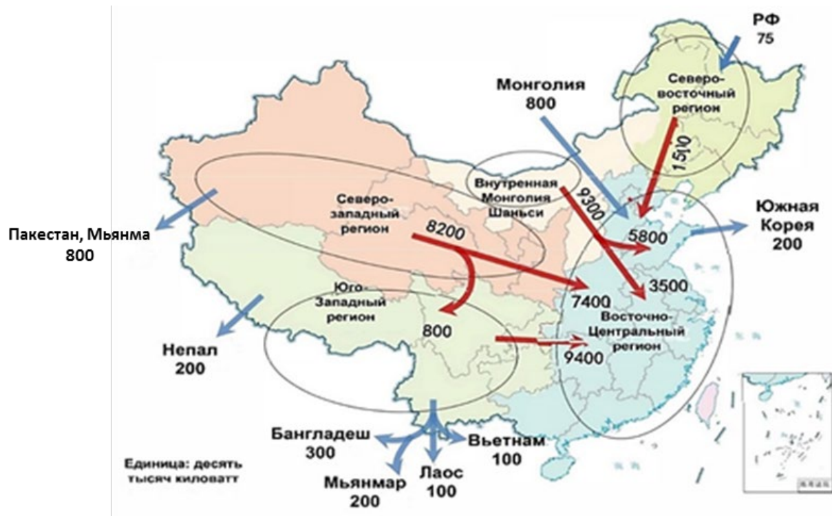
Рисунок 1.6 – Схематическая диаграмма транснациональных, межрегиональных и межпровинциальных потоков электроэнергии Китая в 2025 г. (единица измерения мощности в 10 тыс. кВт)
