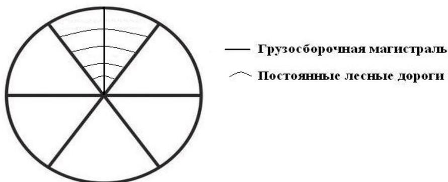
Рисунок 1.4 – Расположение дорожной сети на энергетической плантации
