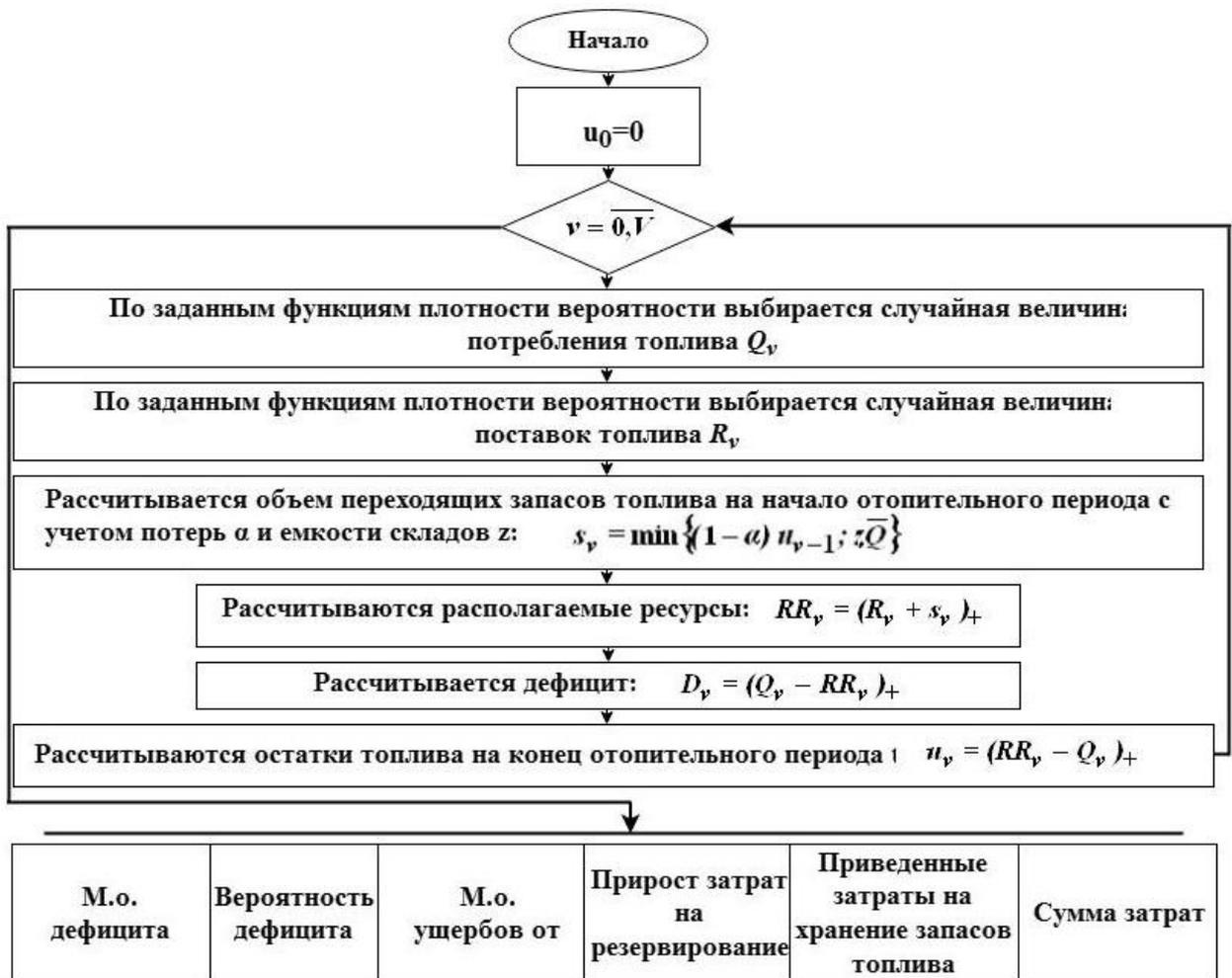
Рисунок 3.2 – Схема анализа надежности топливоснабжения с энергетических плантаций
