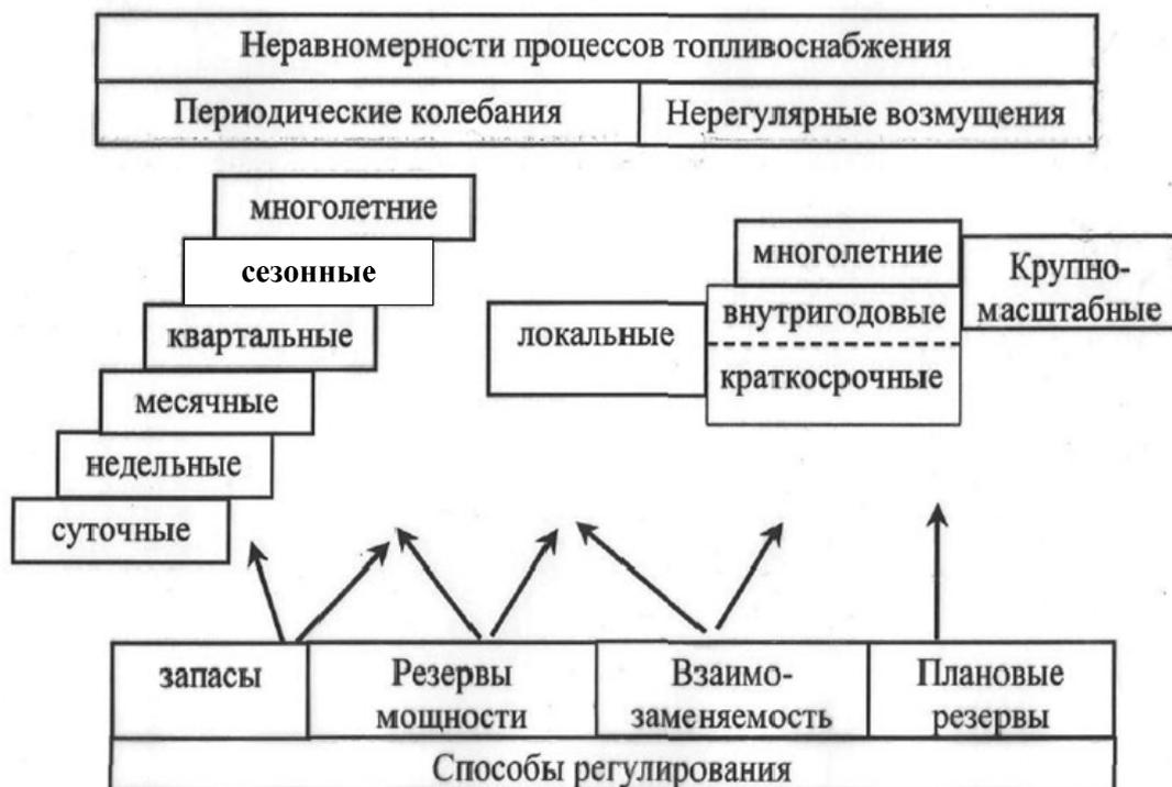
Рис. 1. Виды неравномерностей процессов топливоснабжения и способы их регулирования.
