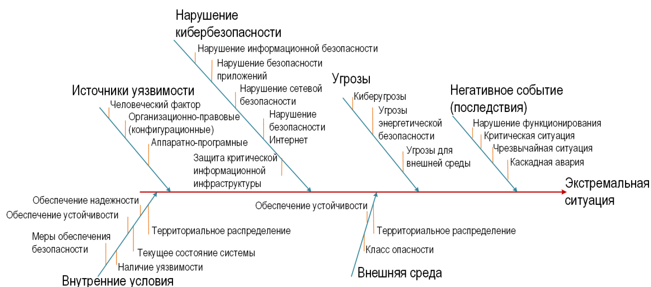
Рисунок 2.11 – Экстремальная ситуация в энергетике, вызванная реализацией киберугрозы на объекте энергетики (в нотации диаграмм Исикавы)
