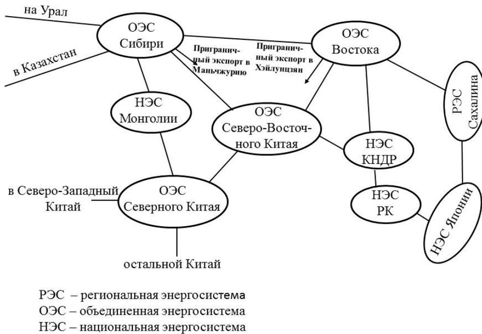
Рисунок 5.3 – Расчетная схема МГЭО в СВА
