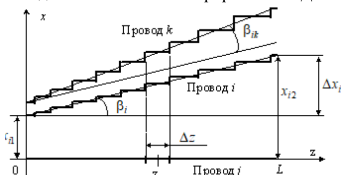
Рис. 2. Схема для анализа емкостной связи
