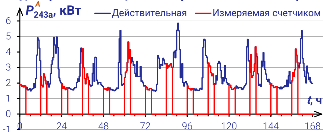
Применение импульсных приборов для блокировки счетчика
