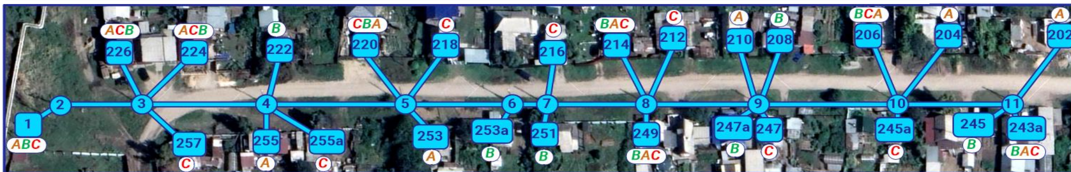
Фазы подключения счетчиков к распределительной сети
