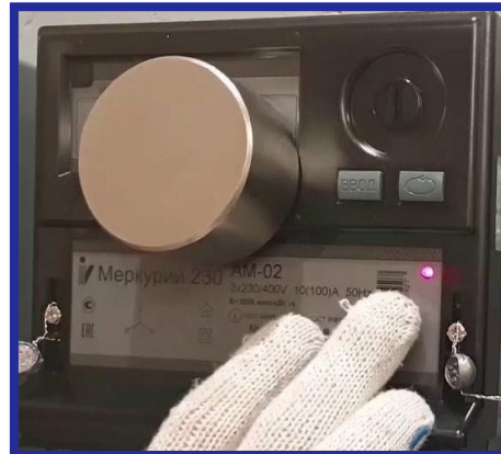
Блокировка работы (фотографии слева на право): импульсными излучателями; неодимовыми магнитами; герконами
