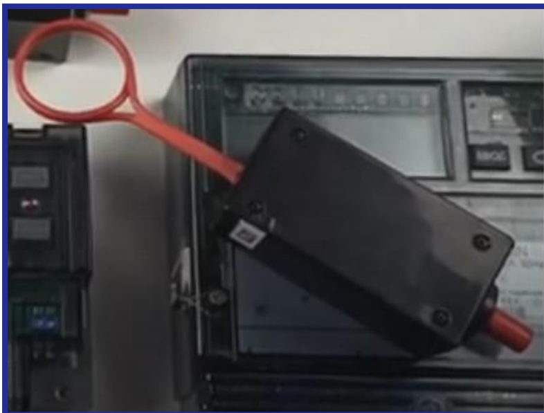
Применение импульсных приборов для блокировки счетчика
