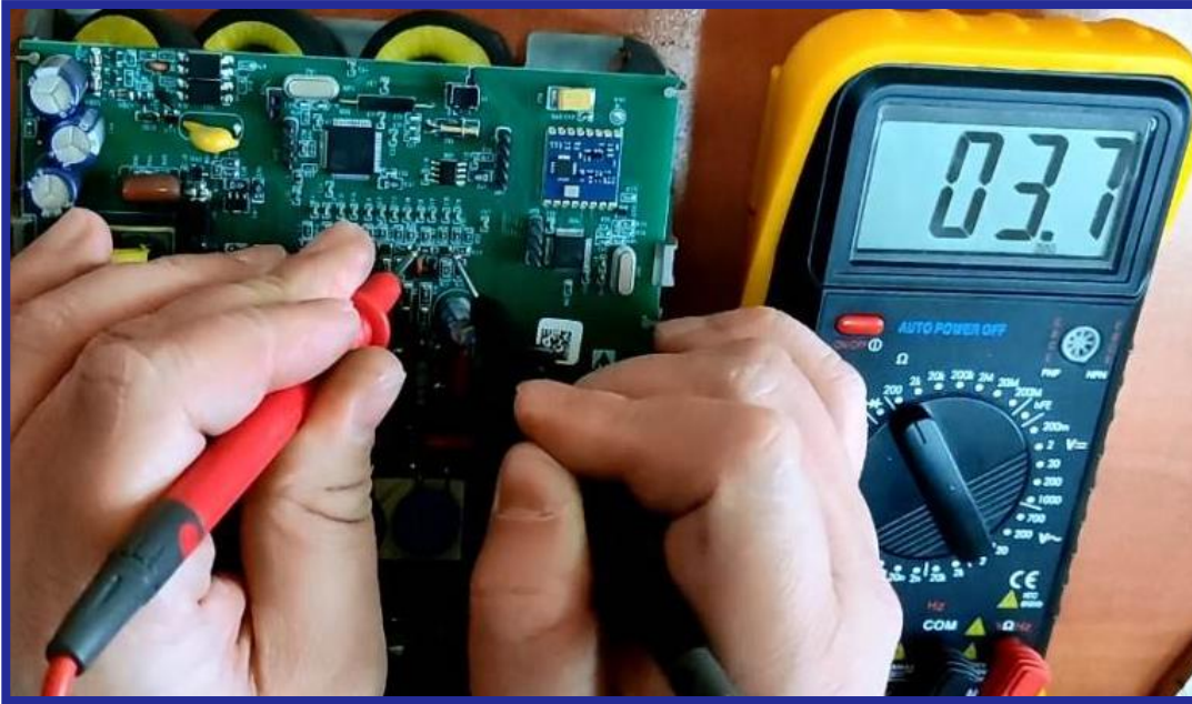
Изменение сопротивления в токовых цепях счетчика с 10 Ом до 3,7 Ом
