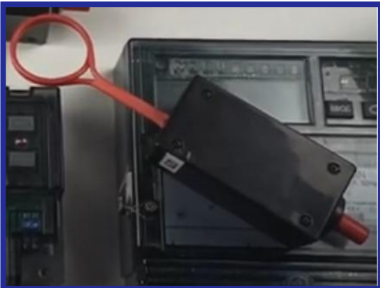
Блокировка работы (фотографии слева на право): импульсными излучателями; неодимовыми магнитами; герконами
