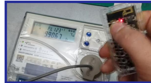
Уменьшение показаний с 2,677 кВт заводского режима пультом радиомодуля до 990,7 Вт
