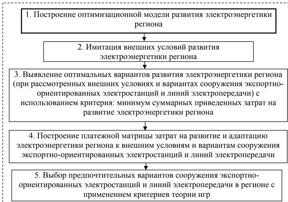
Рис. 1. Принципиальная схема методического подхода для оценки сравнительной эффективности вариантов сооружения экспортно-ориентированных электростанций и линий электропередачи в условиях неопределенности развития электроэнергетической системы региона
