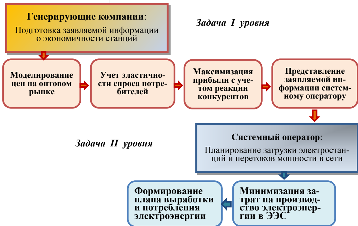
Рис. 10. Взаимодействие задач при планировании режимов электроэнергетической системы в условиях оптового рынка.
