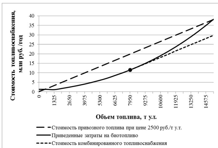
Рисунок 1 – Зависимость стоимости топливоснабжения из разных источников от объема потребления топлива
