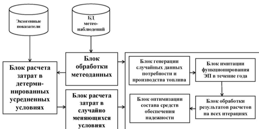
Рисунок 6 – Архитектура ПВК «Анализ надежности топливоснабжения с ЭП»
