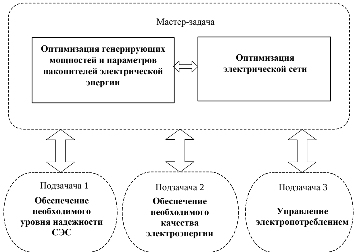
Рисунок 2.4 –Общая схема использования идеологии декомпозиции Бендерса
