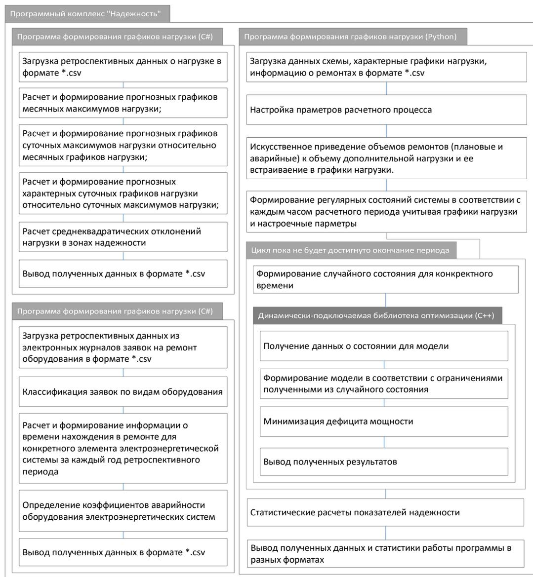
Рисунок 1 – Структура программного комплекса «Надёжность» для оценки балансовой надёжности ЭЭС
