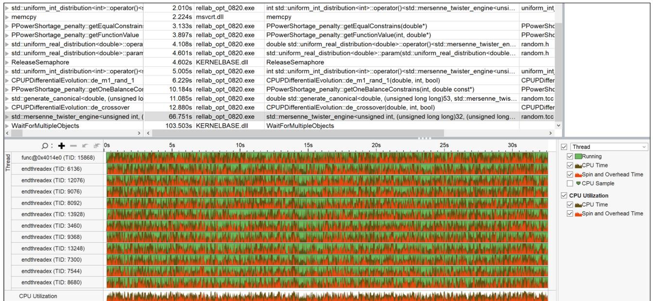
Рисунок 3.4 – Результаты тестирования первоначальной программы блока оптимизации на наличие утечек памяти и время исполнения отдельных операций
