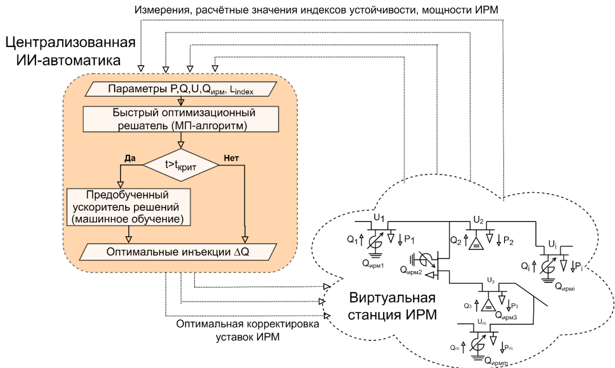
Рисунок 3.8 – Общая схема реализуемой централизованной ВЭ-СКРМ на базе концепции ВЭ
