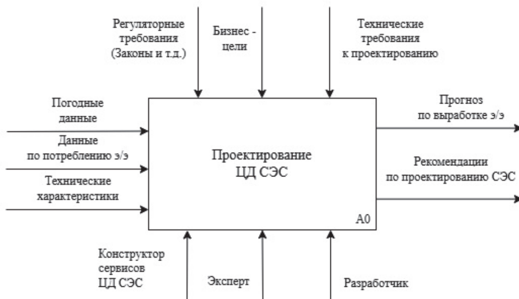
Рисунок 2.8 – Проектирование цифрового двойника солнечной электростанции
