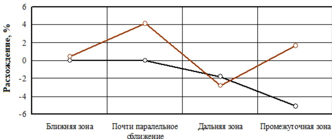
**Рисунок 1.13. Сопоставление взаимных сопротивлений параллельного и непараллельного сближений**
