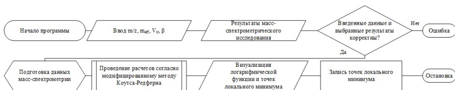
Рисунок 3 – Блок-схема, отражающая алгоритм работы программно-вычислительного комплекса
