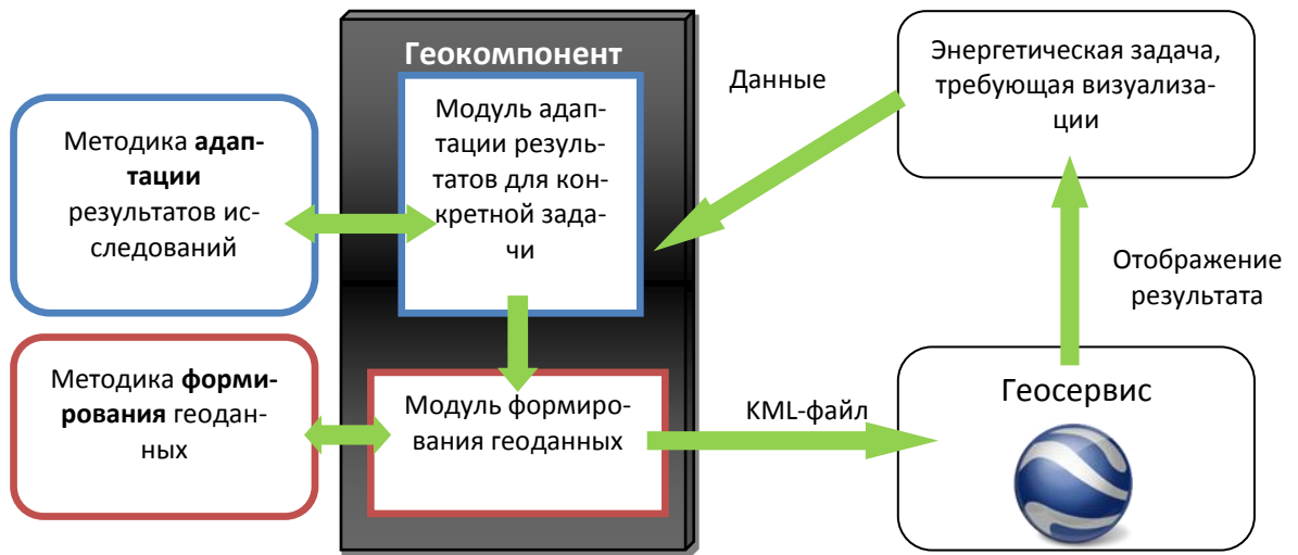
Рис. 38. Технология 3D-визуализации результатов исследований и геоданных для поддержки принятия решений в энергетике
