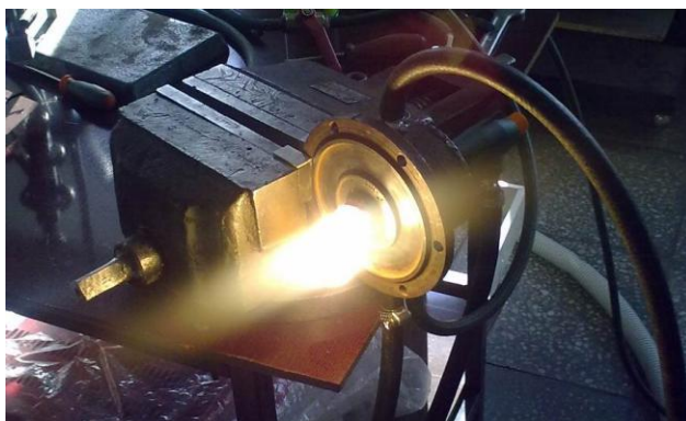
Рис.40. Испытание горелки для камеры сгорания.
