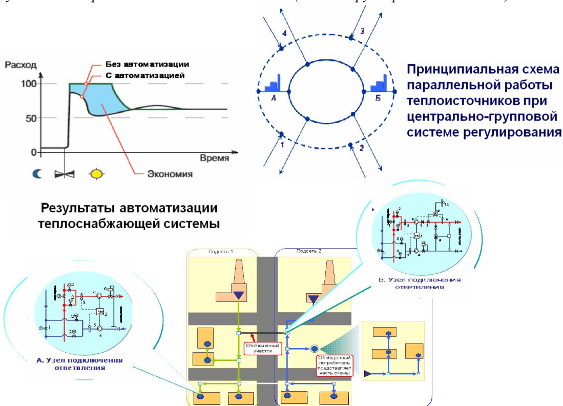
Рис. Инновационные принципы построения энергоэффективной теплоснабжающей системы.
