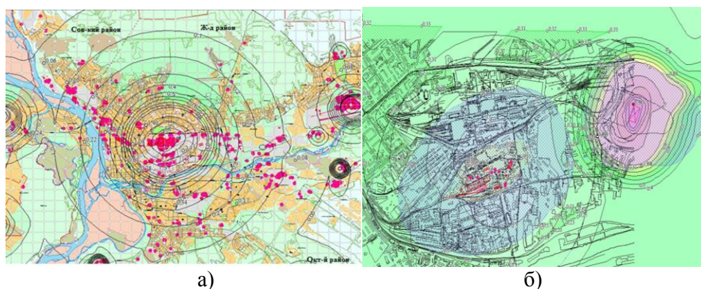
Рисунок 5 – Концентрация пыли неорганической в долях ПДК, формируемое выбросами Улан-Удэнского энергетического комплекса (а) и Улан-Удэнской ТЭЦ-1 (б)
