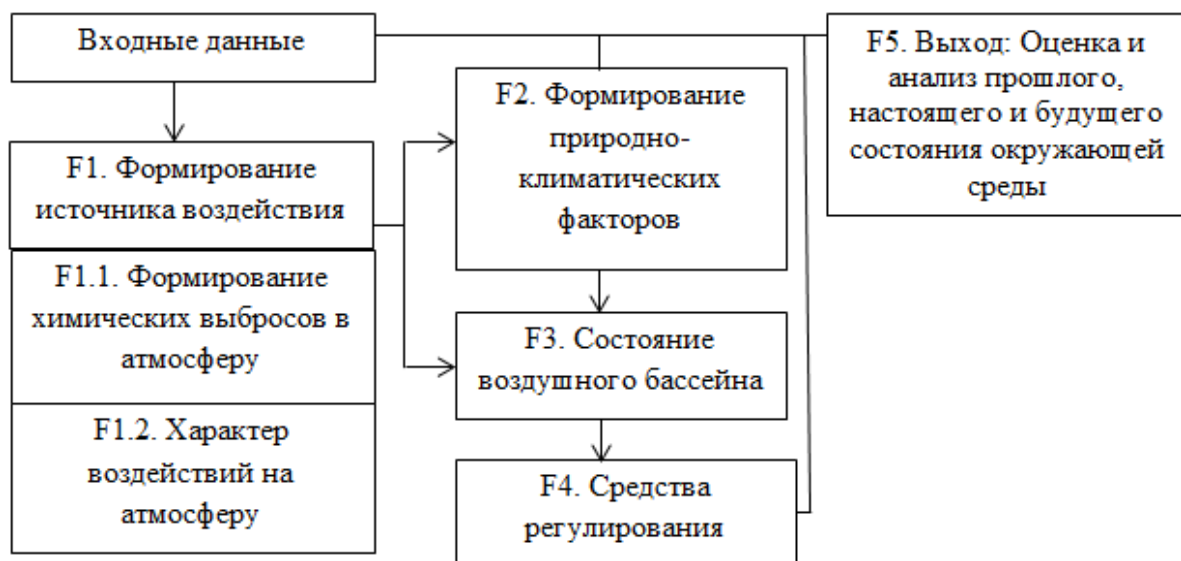
Рисунок 3 – Структурная модель системы «производство – окружающая среда».
