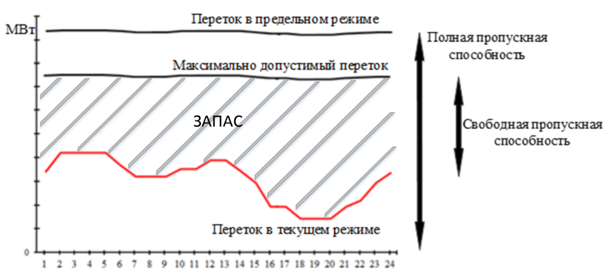
Рис. 1.4. Перетоки активной мощности в разных режимах
