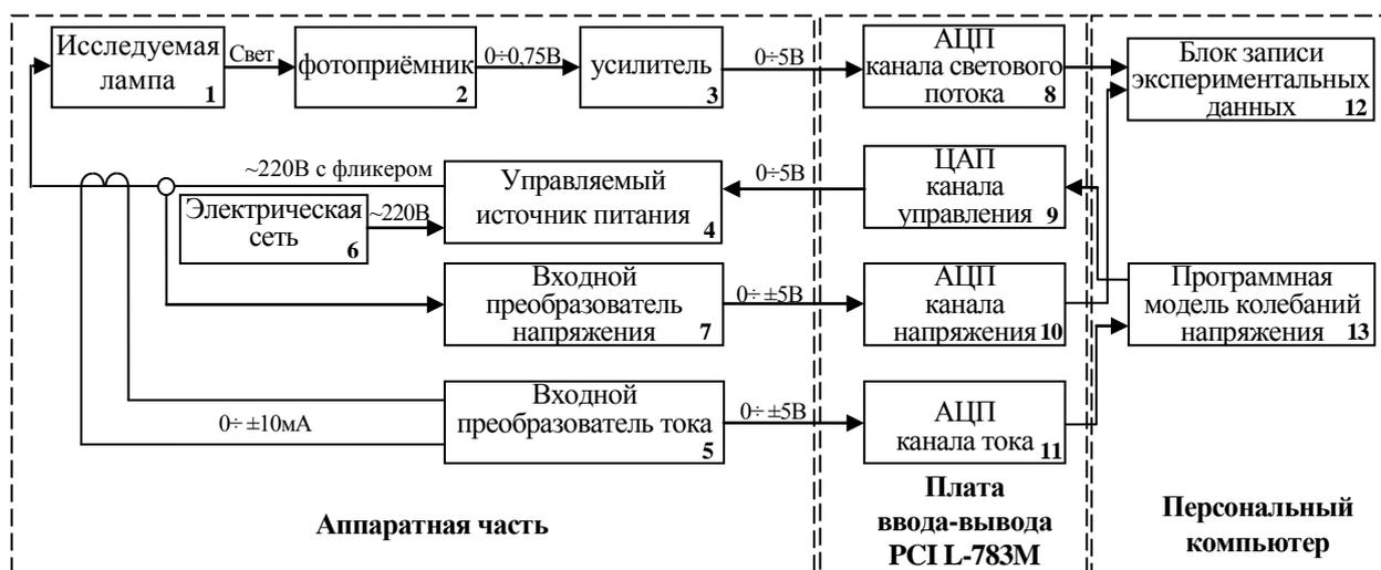
Рисунок 2.7 – Блок-схема аппаратно-программного комплекса
