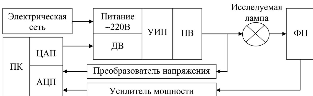
Рисунок 2.5 – Функциональная схема аппаратно-программного комплекса
