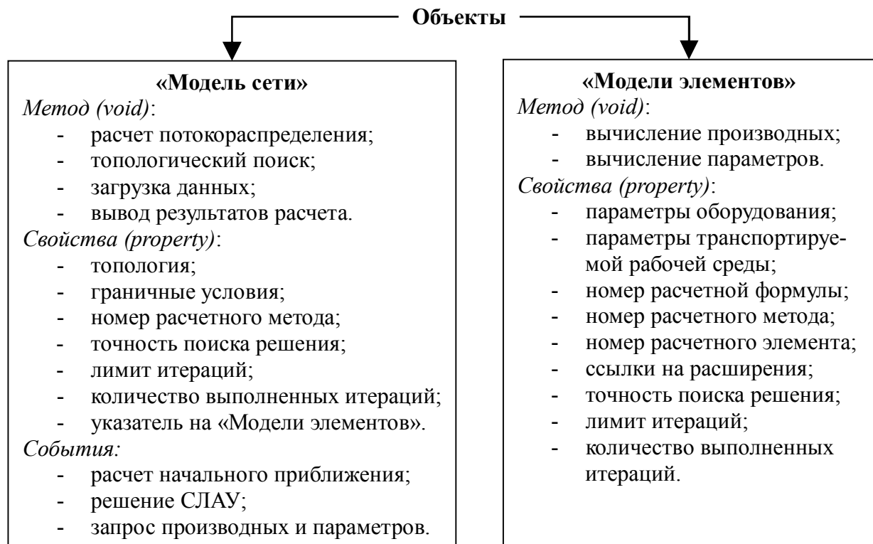
Рисунок 3.1. Применение технологии ООМ ГЦ путем разделения на объекты по физическому смыслу.
