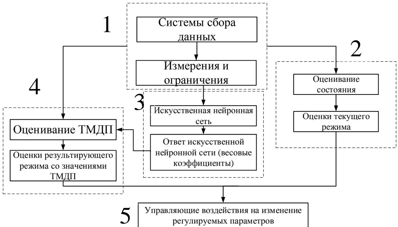
Рис.10. Блок-схема методического подхода определения МДП и вычисления СПС
