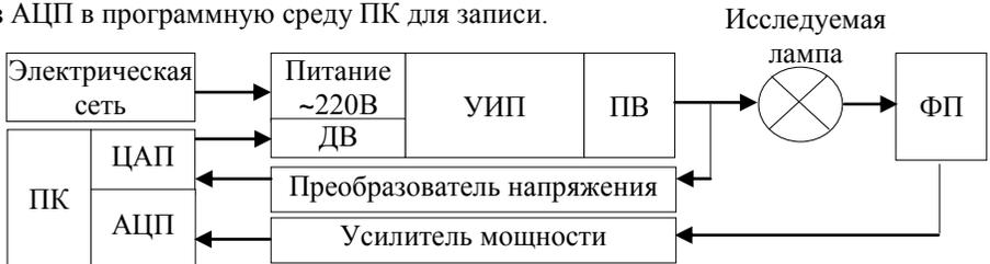
Рисунок 7 - Функциональная схема аппаратно-программного комплекса
