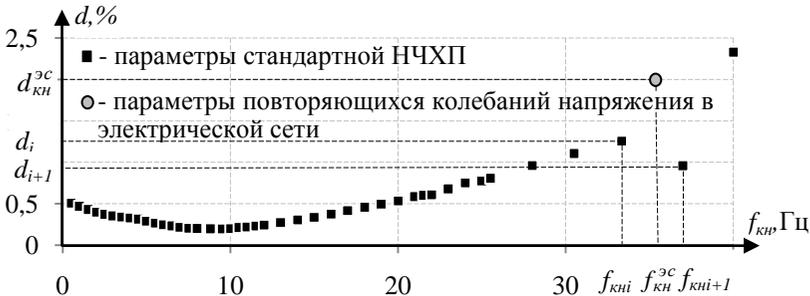
Рисунок 11 – Графическая интерпретация стандартной НЧХП и колебаний напряжения в электрической сети
