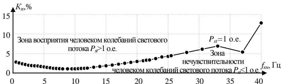
Рисунок 6 – Кривая допустимых колебаний светового потока
