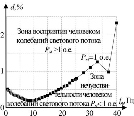
Рисунок 2 – Графическое изображение стандартной НЧХП
