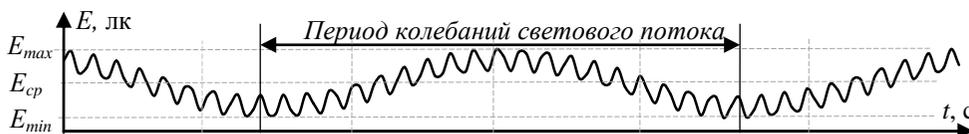
Рисунок 5 – График колебаний светового потока лампы накаливания
